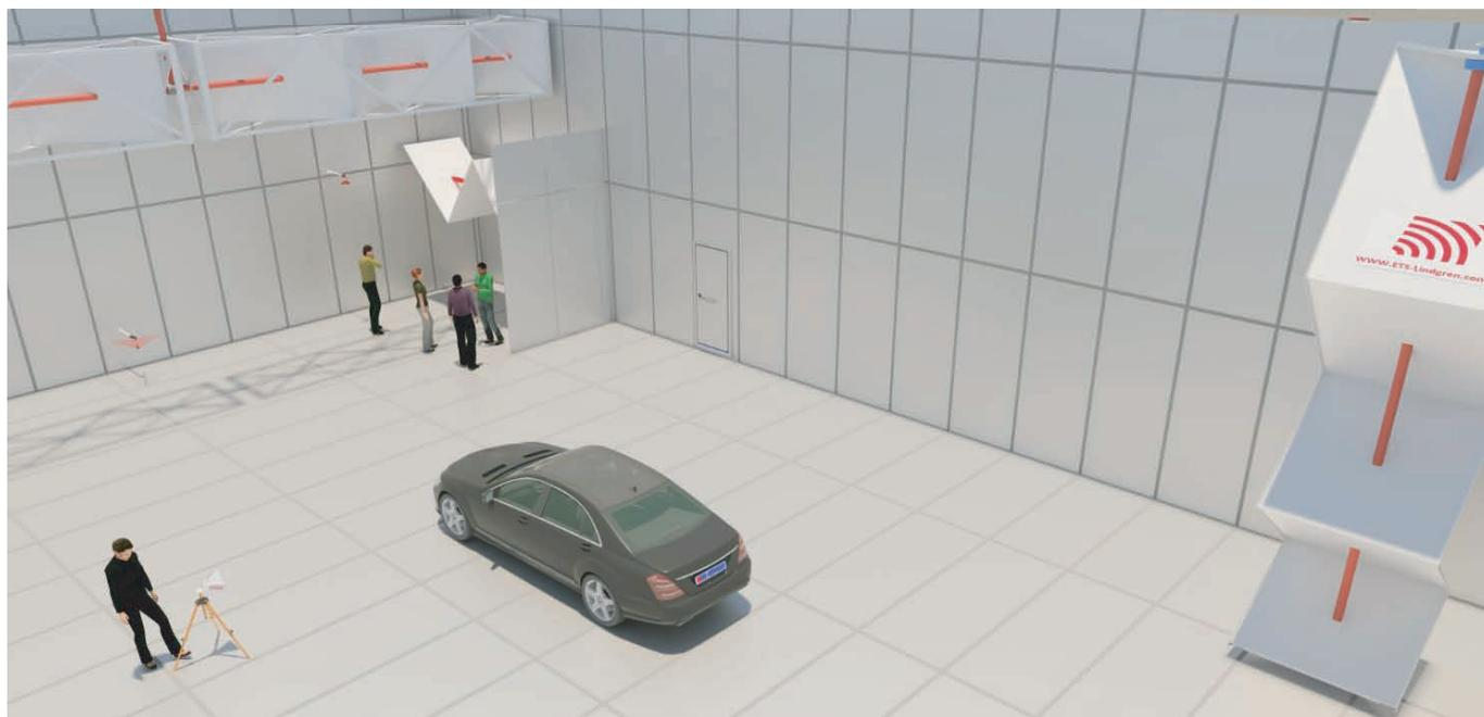
リバレーションチャンバーは、全周囲を金属反射面に囲まれたシールドルーム内部に取り付けられたチューナー（又はスタラー）と呼ばれる金属製の攪拌板を回転させることにより、位相の変化を発生させ安定した電磁界試験環境を作り出すことができます。
