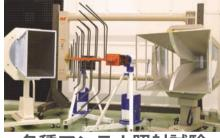
ンテナ照射試験 10kHzから18GHzまで
