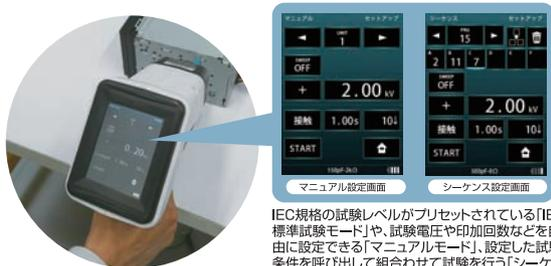
IEC規格の試験レベルがプリセットされている「IEC標準試験モード」や、試験電圧や印加回数などを自由に設定できる「マニュアルモード」、設定した試験条件を呼び出して組合わせて試験を行う「シーケンス試験モード」があります。
